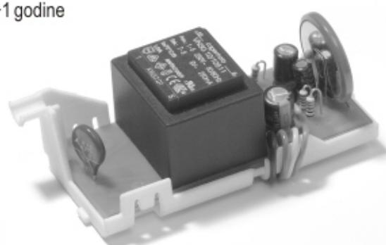
Supercal 531 ima automatski detektor za napajanje.
